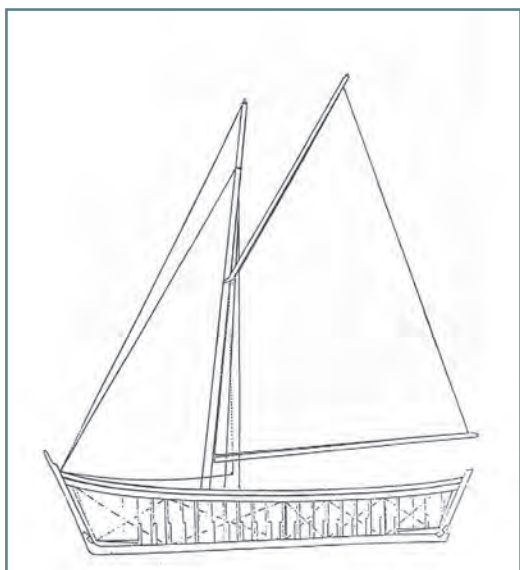
Imaxe 6. Plano completo da lancha xeiteira. (Rianxo, o mar feito tradición)
