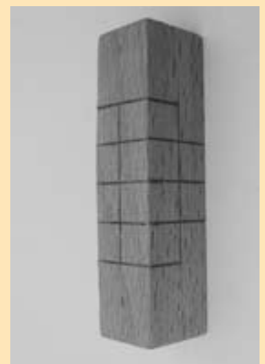
Zona onde se realizan os cortes cúbicos.
