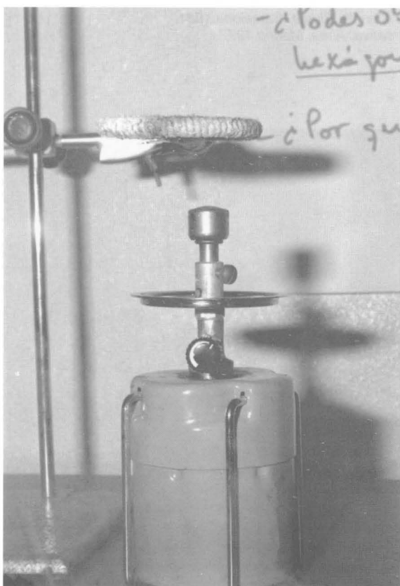
3.-Cordel que non arde na chama: o cordel está enrolado nun aro de metal, que por ser mellor conductor da calor absorbe a súa maior parte evitando que o cordel alcance a temperatura de ignición.
